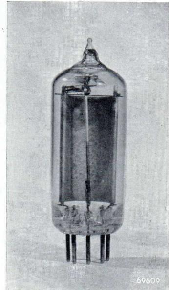
Fig. 12. Phototube 90 CV.
