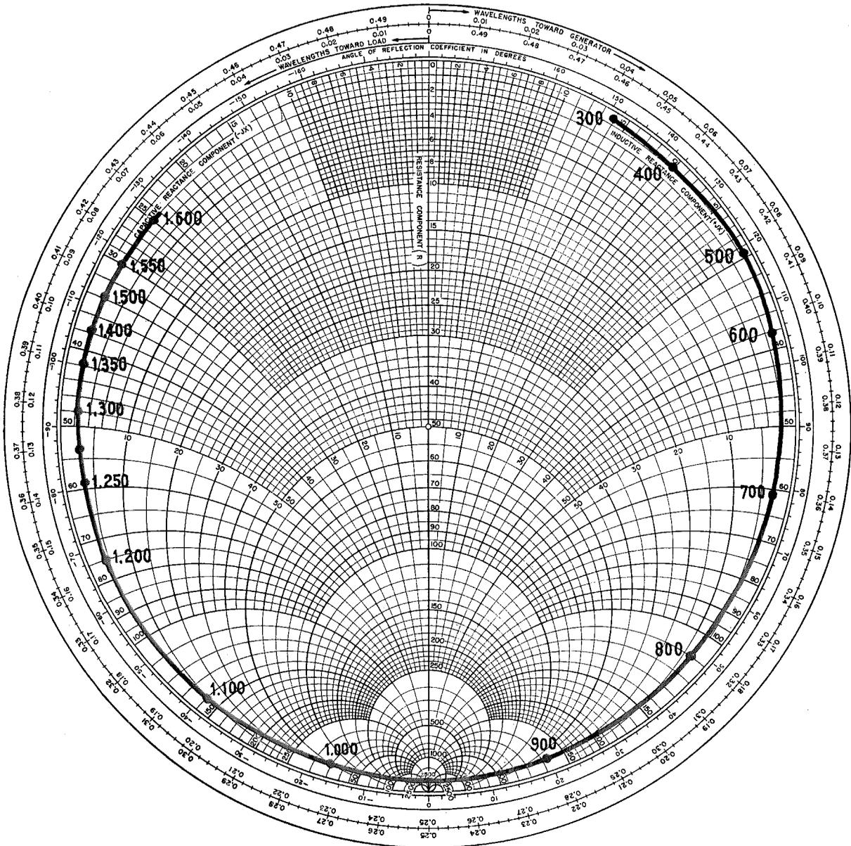
Fig. 4. — Admittance de sortie, à froid, de la triode E 88 C
