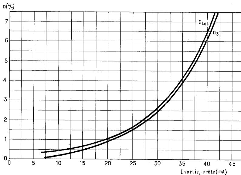
Fig. 1. — Tube S. Q. type E 55 L = Distorsions totales D et D<sub>3</sub> en fonction du courant de sortie (crête).
