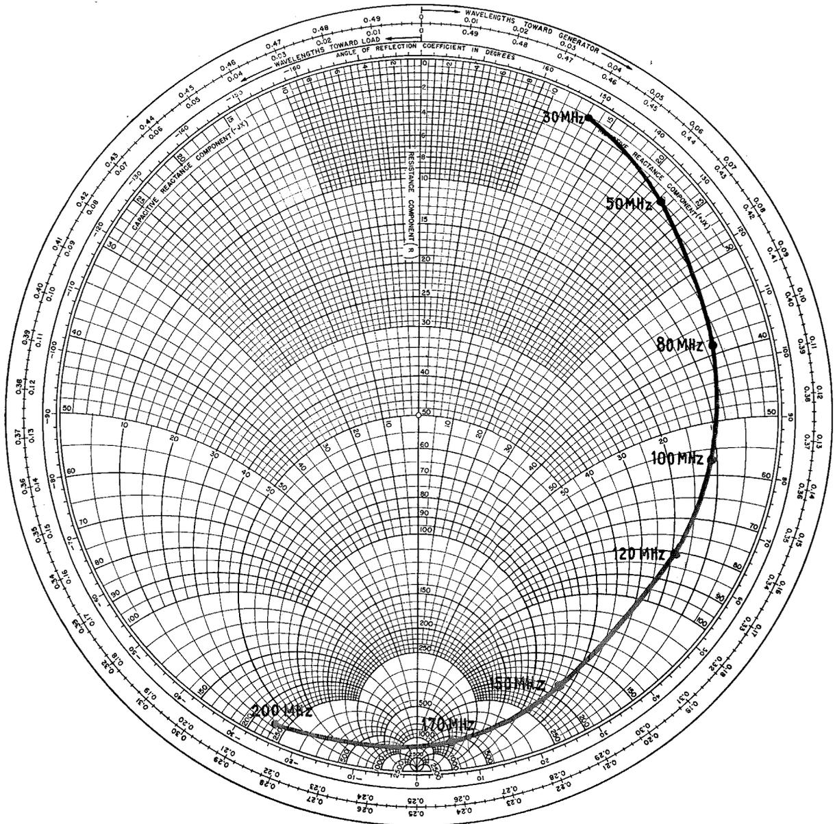
Fig. 2. — Admittance d'entrée, à chaud, du tube E 55 L
