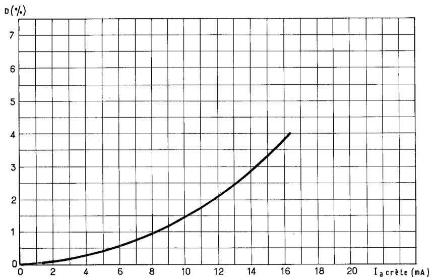
Fig. 5. — Distorsion totale D% en fonction de  $I_a$  (crête) pour le tube E 810 F
