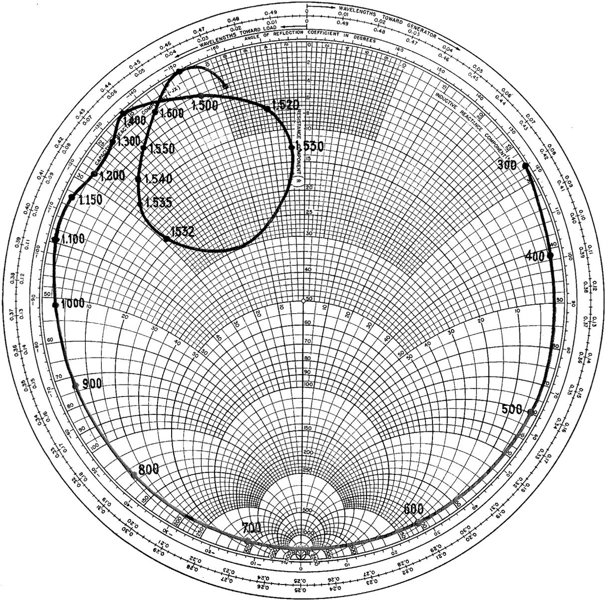
Fig. 3. — Admittance d'entrée, à froid, de la triode E 88 C
