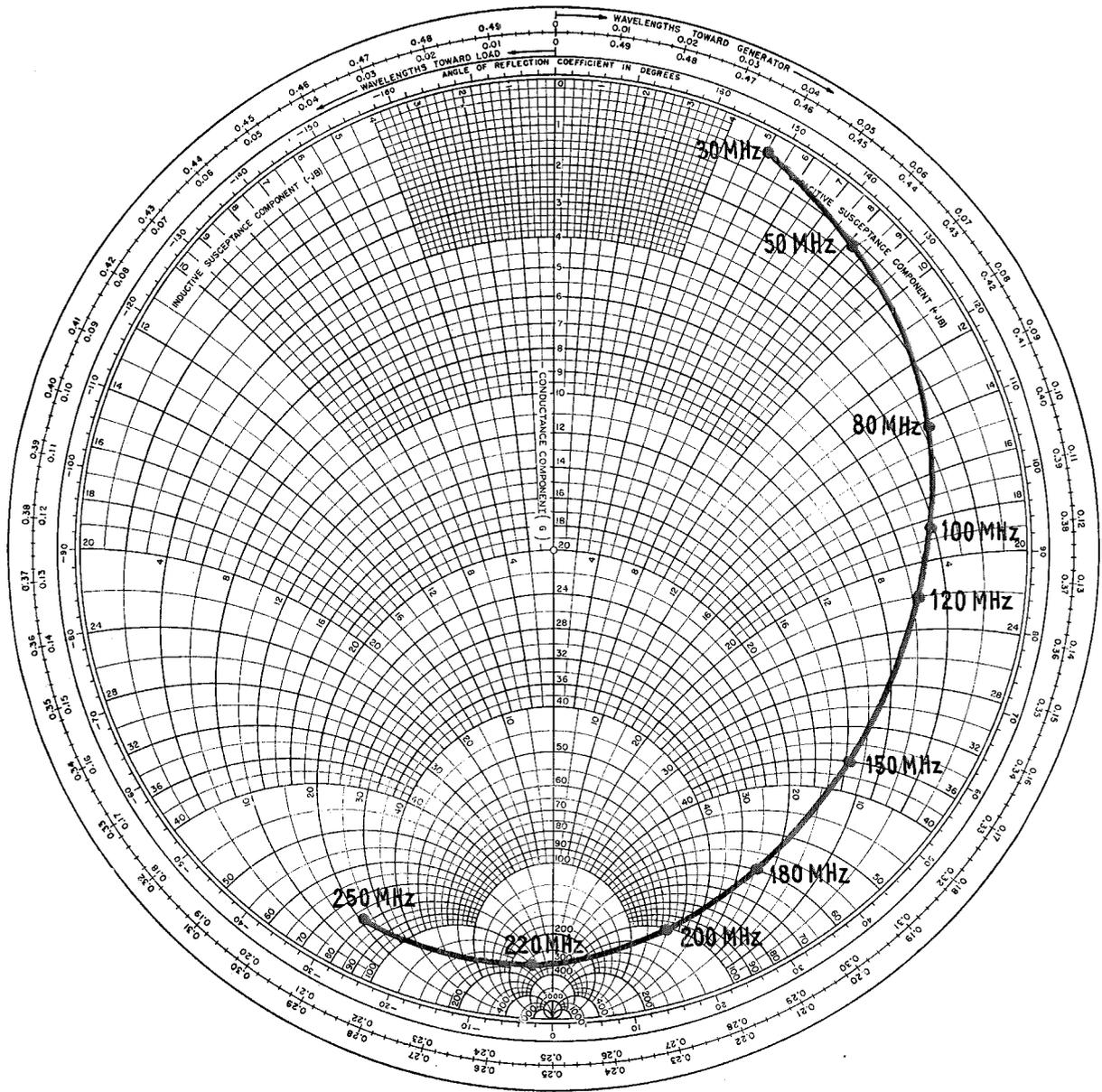
Fig. 6. — Admittance d'entrée, à chaud, du tube E 810 F dans un équipement.
